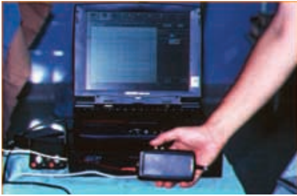
Figura 3. Equipo empleado para la generación de impulsos eléctricos que se puede emplear también para electro-miografía y análisis de potenciales evocados, fue un ATI Delphos PE®. Genera pulsos repetitivos de onda cuadrada de 0.2 a 0.3 mseg de duración. Se lo empleó en prostatectomía radical en humanos para la detección de las bandeletas neurovasculares.
